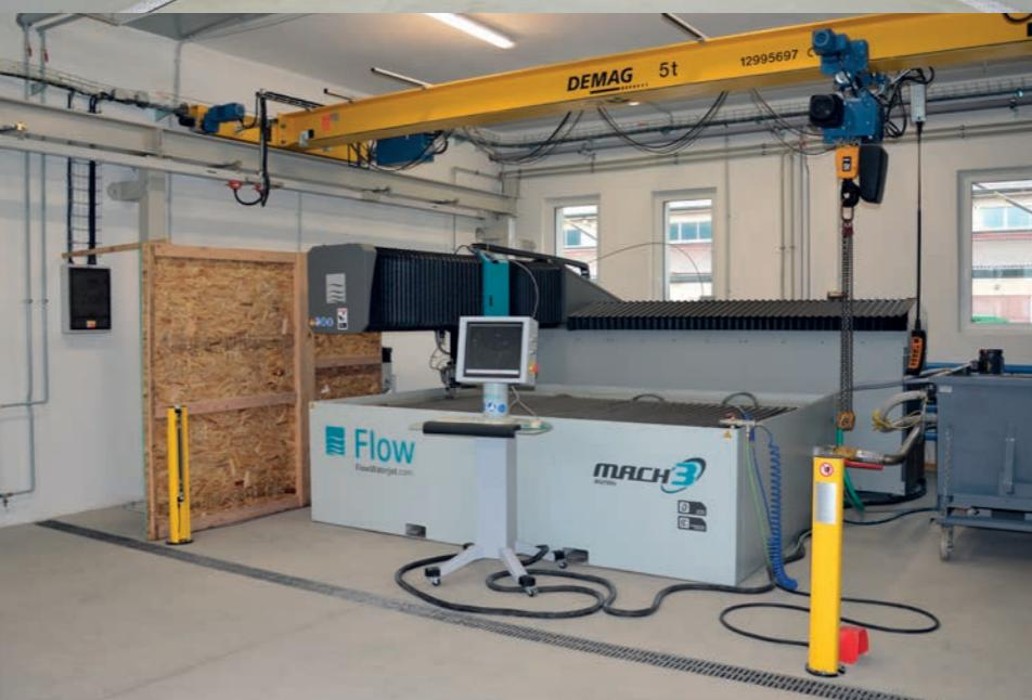
(např. stříhání, vrtání, soustružení). Výhodou technologie je možnost dělení materiálu v širokém rozsahu jeho tloušťky, tepelně neovlivnění oblasti v okolí řezu a možnost vyřezat libovolný geometrický tvar, který je importován z DXF souborů.
