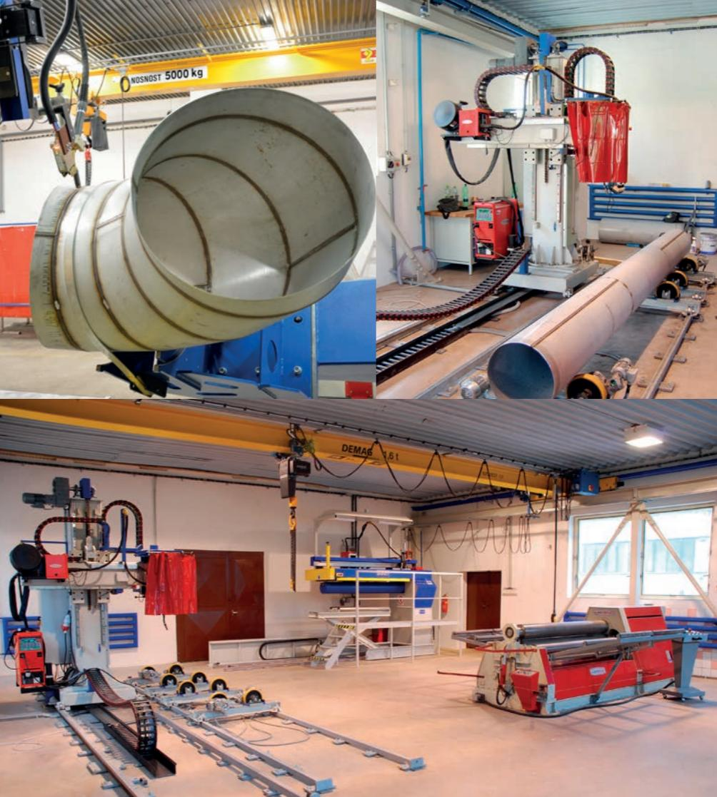
Výroba probíhá ve většině případů z přístřihu, které jsou dodávány v přesně stanovených rozměrech dle požadované dimenze trub.
