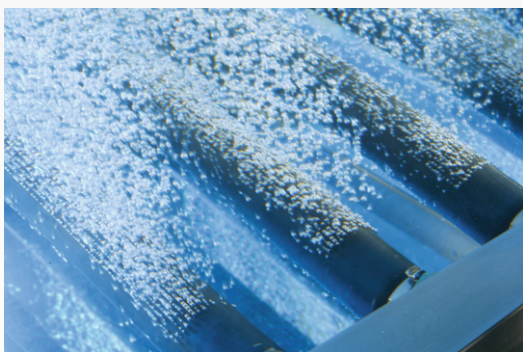
LABORATORNÍ TESTOVÁNÍ HADICOVÝCH MEMBRÁN
