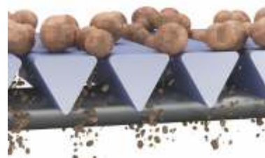
POVRCH TECHNOLOGIE VEE-WIRE®, KTERÝ ZACHYCUJE FILTRAČNÍ MATERIÁL
